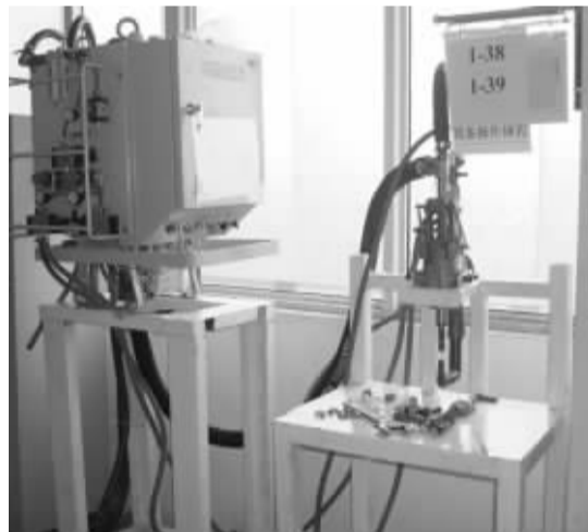
从悬挂式点焊机改造的固定式点焊机
